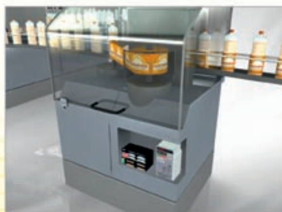
L'arresto sicuro è controllato da un modulo I/O di sicurezza, che garantisce inoltre il monitoraggio dei finecorsa di sicurezza.
